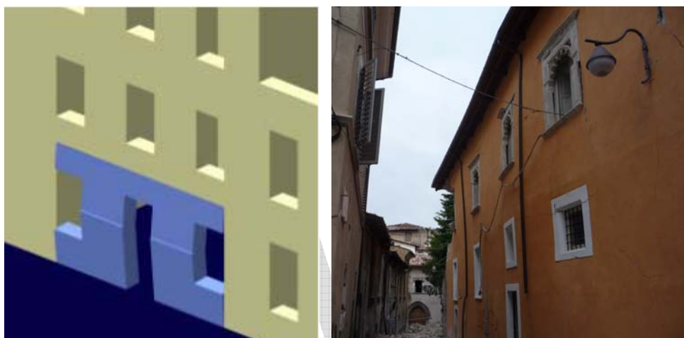
Figura 10: Schema ed esempio di flessione verticale
