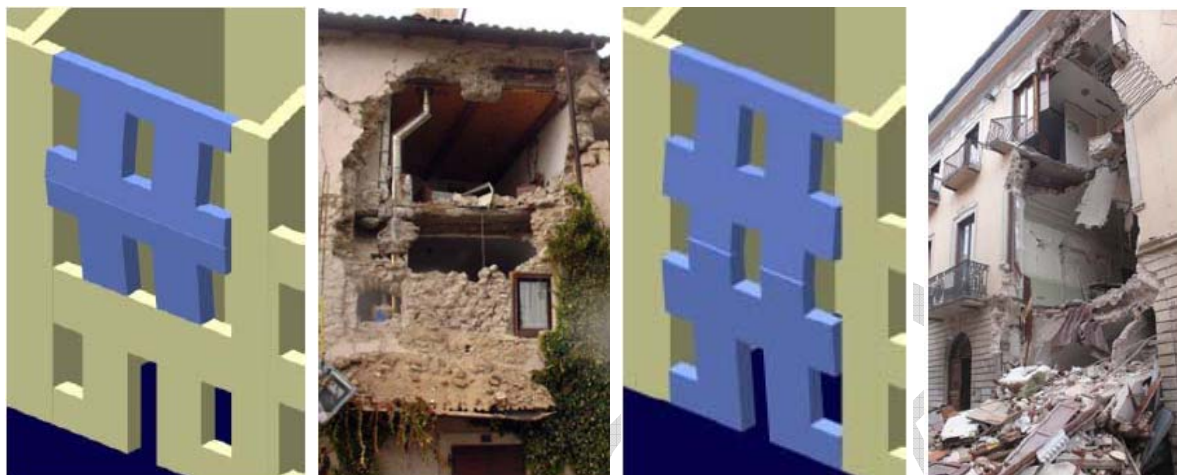
Figura 12: Schemi ed esempi di flessione verticale su più piani
